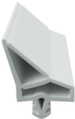
Die **Zimmertürdichtung ZT079** in **weiß** ist ein Dichtungsprofil für **senkrechte Nuten** zum Türblatt und wird in Zimmer- und Innentüren eingesetzt. Die vorhandene Hohlkammer gleicht unterschiedliche Abstände zwischen Türblatt und Holzzarge aus. Dadurch wird die notwendige Abdichtung für Schallisolierung und Zugluft gewährleistet und für beste Wärmeisolierung gesorgt.
